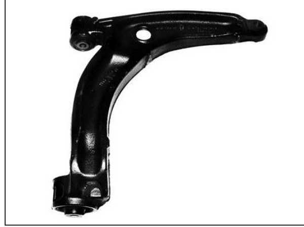
Şekil 1. Metalografik ve mekanik incelemelerde kullanılan numunelerin çıkarıldığı salıncak
