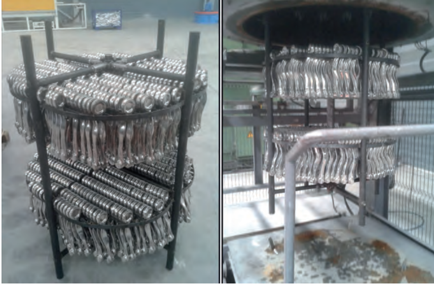
Şekil 2. Tasarlanan ısıtma işlemi için geliştirilen sepetin ve parçaların konumlandırılması ve fırına yüklenişini gösteren iki fotoğraf.
