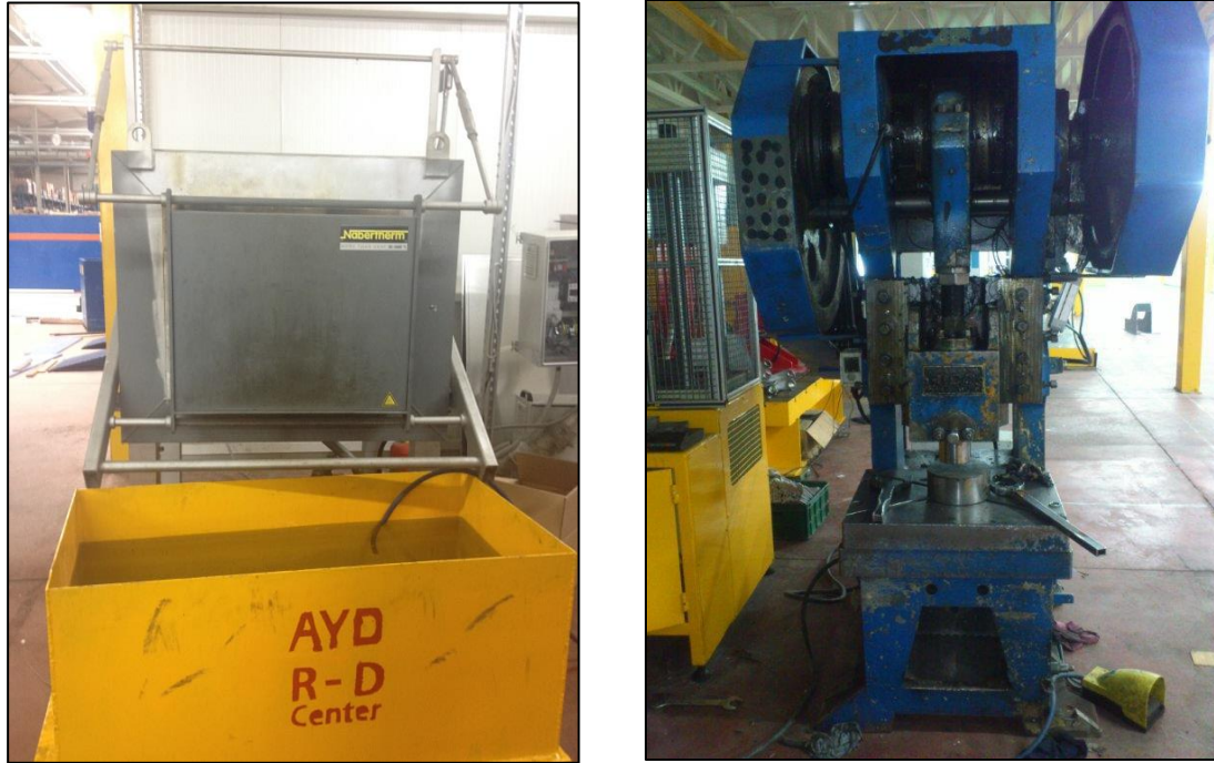
Şekil 1. Deneysel çalışmada kullanılan ısıtma fırını ve pres makinası
