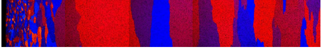
Şekil 3. Pres çıkış sıcaklığı 470 °C dövme sıcaklığı 420-430 °C olan T6 işlemi görmüş numune
