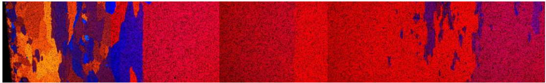
Şekil 6. Pres çıkış sıcaklığı 480 °C, dövme sıcaklığı 490-500 °C olan T6 işlemi görmüş numune
